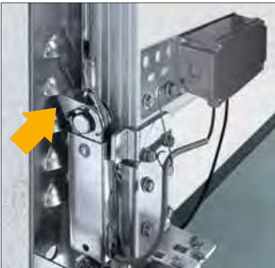
Der Verriegelungshaken der Aufschiebesicherung rastet beim Hochhebeln des Tores automatisch fest ein.
