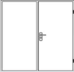
**Feuerschutztür EI30, 2-flügelig - Maßanfertigung von - bis / LZ = liches Zargenmaß**
